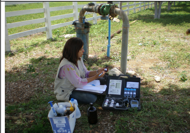
Figura 33: Etiquetagem de amostras de água em vidro âmbar, para análise de isótopos e de compostos semi-voláteis.
