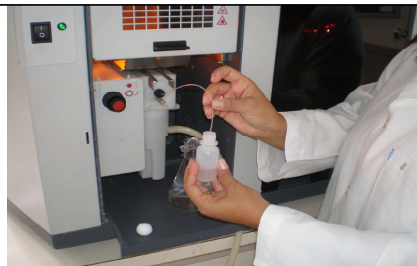
Figura 49: Determinação de metais: \text{Cu}^{+2} , \text{Zn}^{+2} , \text{Pb}^{+2} , \text{Fe}^{+2} e \text{Ni}^{+2} , por Espectrometria de Absorção Atômica (LEPETRO/UFBA).
