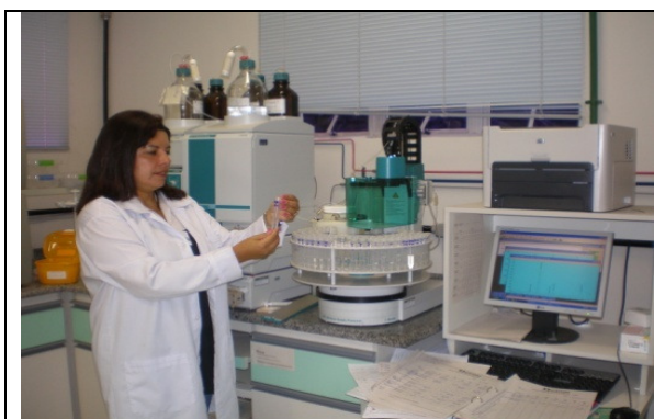
Figura 38: Preparação das amostras para colocar no Cromatógrafo Iônico (LAMIN/CPRM-RJ).
