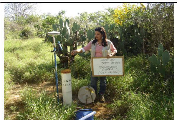
Figura 22: Leitura dos dados de cota e coordenadas UTM (DGPS) e medida do nível estático (NE) de poço desativado.
