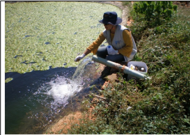
Figura 31: Ambientação dos frascos a serem utilizados na coleta com água do poço.
