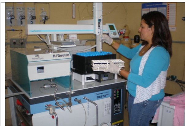
Figura 42: Colocação das amostras preparadas no espectrômetro de massas para análise isotópica (LFNA-UFBA).
