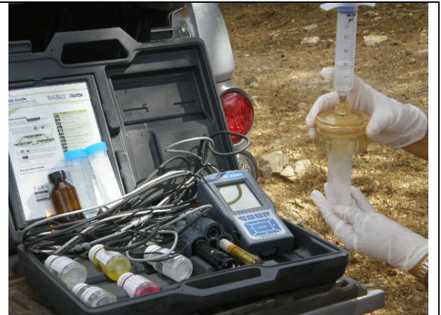
Figura 32: Filtragem das amostras e preparação da sonda multiparâmetros para medida de (pH, condutividade elétrica, temperatura e STD) “in situ”.
