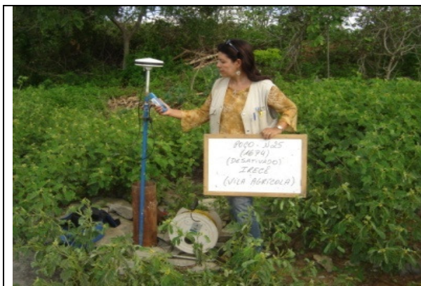
Figura 21: Posicionamento do GPS diferencial (DGPS) e leitura dos dados.
