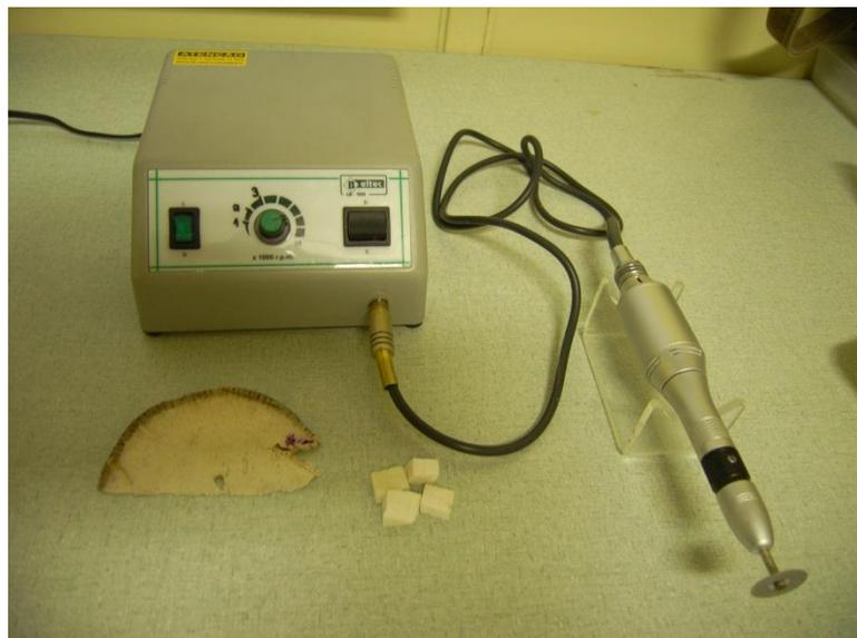
Figura 7: Motor de bancada utilizado para subamostragem das placas em intervalos de 2mm.
