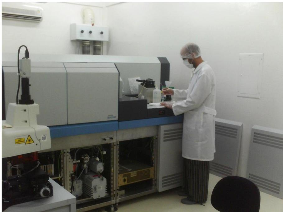
Figura 13: MC-ICP-MS utilizado na determinação da razão isotópica das amostras de corais.
