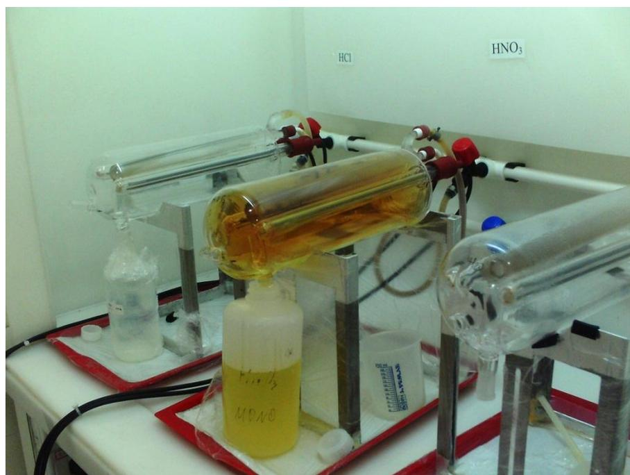
Figura 3: Destilador de quartzo com resistências elétricas revestidas com tubos de quartzo.
