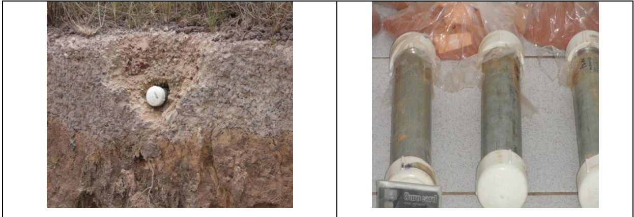
Figura 18 A – Penetração do tubo de coleta de amostra para datação pelo método de luminescência opticamente estimulada. Figura 18 B – Amostra identificada e orientada para envio ao laboratório de datação.
