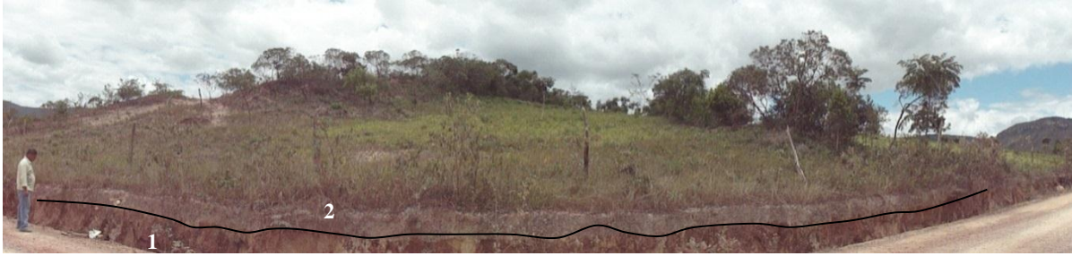
Vista geral do afloramento mostrando o contato entre: 1- Fm. Mangabeira/Açuruá e a cobertura do cascalho laterítico.
