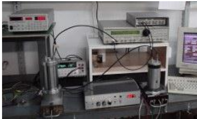
Figura 20 – Equipamento de medida de Luminescência Ópticamente Estimada (LOE) – Departamento de Física Nuclear/Instituto de Física da USP.
