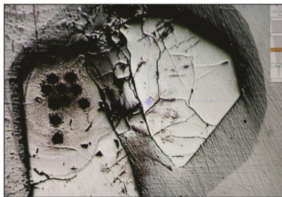
Figura 1.5 – Sistema Laser Resonetics M-50E acoplado ao espectrômetro de massa com ionização por Plasma ICP-MS Agilent 7500 cs, inteiramente comandado por computador e equipado com um Laser ATL de pulso ultracurto (<4 ns). À esquerda, visualização no monitor de um cristal de zircão após as análises com o Laser. O diâmetro dos spots é regulável entre 4 e 100 \mu\text{m} .
