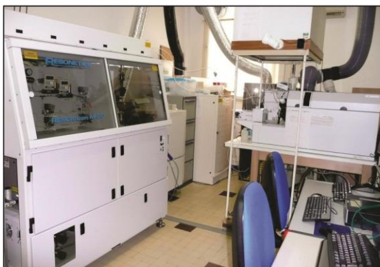
Figura 1.5 – Sistema Laser Resonetics M-50E acoplado ao espectrômetro de massa com ionização por Plasma ICP-MS Agilent 7500 cs, inteiramente comandado por computador e equipado com um Laser ATL de pulso ultracurto (<4 ns). À esquerda, visualização no monitor de um cristal de zircão após as análises com o Laser. O diâmetro dos spots é regulável entre 4 e 100 \mu\text{m} .
