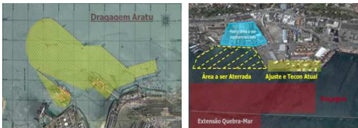
Figura 4 - Dragagem de aprofundamento da bacia de evolução, berços de atracação e canal de acesso no Porto de Aratu (Esquerda) e Porto de Salvador (Direita), Baía de Todos os Santos. Fonte: CODEBA, 2010.
