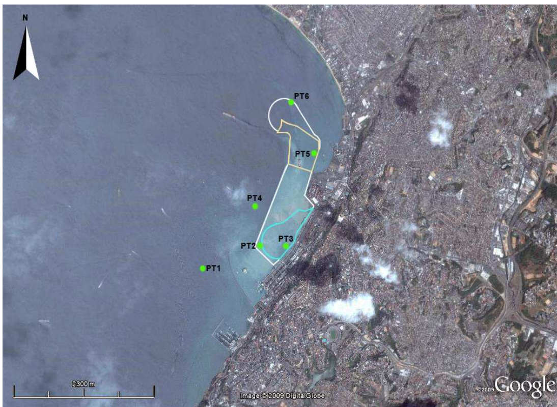
Figura 10 - Porto de Salvador; Baía de Todos os Santos, com a delimitação da área de dragagem e a indicação dos pontos de amostragem (PT1-Estação 1 1; PT2 – Estação 2; PT3 – Estação 3; PT4 – Estação 4; PT5 – Estação 5; PT6 – Estação 6).
