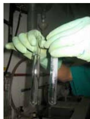
3 Verificar o aparecimento de um precipitado branco (turvação) indicativo da presença de cloreto. Precipitado de  $AgCl$  (cloreto de prata). Comparar com o ensaio em branco do outro tubo.
