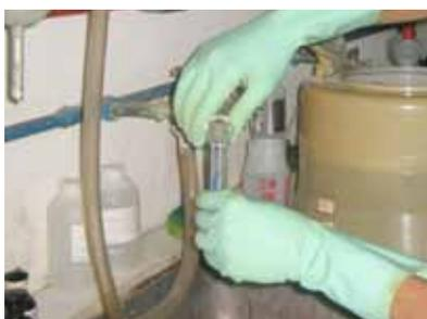
1 Colocar um pouco de cada filtrado em um tubo de ensaio diferente. Usar outro tubo para o teste em branco com água deionizada.
