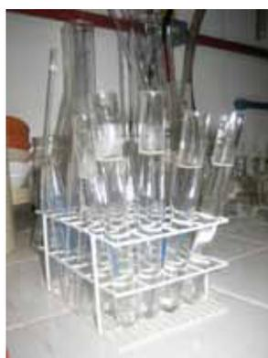
2 Adicionar aos tubos 5 gotas de  $HNO_3$  (ácido nítrico) concentrado. Adicionar também 5 gotas da solução: 1%  $AgNO_3$  (nitrato de prata) em água deionizada.
