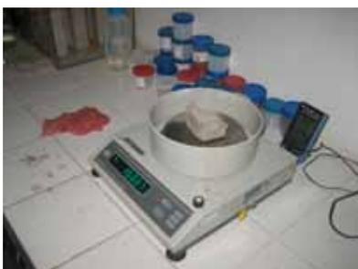
1 Deixar o material na estufa por no mínimo 24hs e depois colocar no dessecador entre 30 e 40 minutos e pesar (amostra seca).
