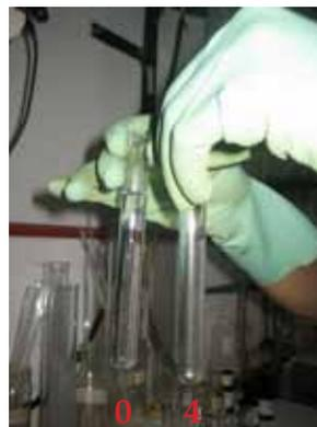
3 Verificar o aparecimento de uma turvação indicativa da presença de sulfato. Precipitado de  $\text{BaSO}_4$  (sulfato de bário). Comparar com o ensaio em branco.
