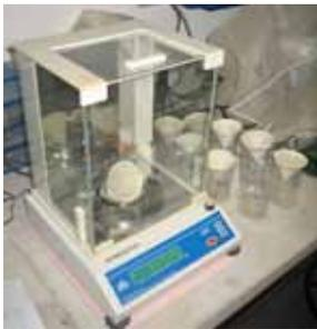
12 Pesar em balança analítica. Calcular a % de finos, % grossos e % ligante e o traço provável da argamassa, conforme tabelas abaixo.
