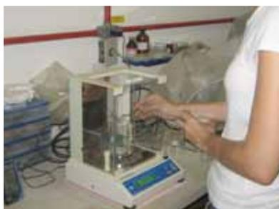
2 Pesar com precisão aproximadamente 10g da amostra em balança analítica. Colocar em um bequer de 150ml previamente pesado e depois umedecer com água deionizada.
