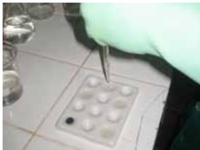
2 Adicionar cinco gotas do reativo: 1% Difenilamina em  $H_2SO_4$  (ácido sulfúrico) concentrado. Fazer um teste em branco com água deionizada.
