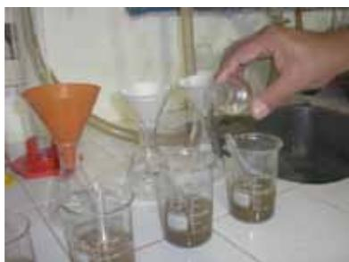
5 Para verificar se o ligante já foi dissolvido completamente, colocar umas gotas de HCl concentrado e observar se ainda há formação de bolhas. Em caso afirmativo, colocar mais ácido, até que isto não mais ocorra. Logo após, adicionar cuidadosamente água deionizada sobre o material e agitar o bequer para que as partículas finas fiquem em suspensão.
