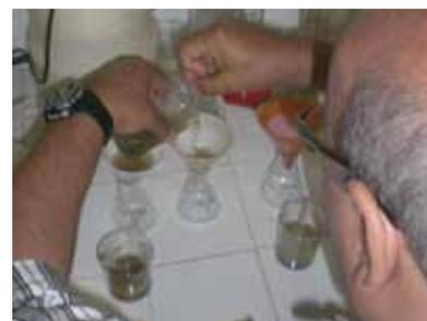
6 Em seguida despejar cuidadosamente o líquido com o material suspenso sobre o papel de filtro, previamente pesado e umedecido com água deionizada para aderir ao funil, tendo o cuidado para não deixar que as partículas maiores também passem.
