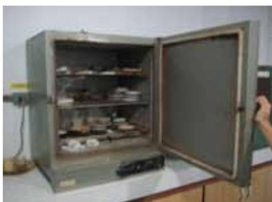
1 Moer a amostra de forma a não quebrar os grãos de areia, em um gral de porcelana e colocar para secar em estufa a temperatura de aproximadamente  $75^{\circ}\text{C}$ , por cerca de 24 horas.
