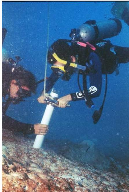
Coleta do testemunho de sondagem, retirado no entorno recifal.
