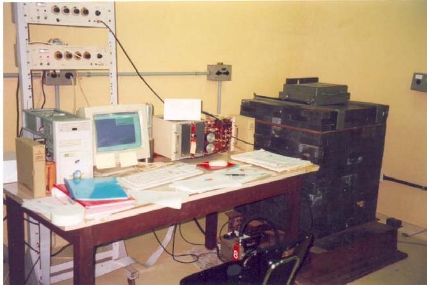
Figura 27 - Espectrômetro de radiação gama, do Laboratório de Física Nuclear, da Universidade Federal da Bahia, o qual foi utilizado para medir a atividade radioativa do Chumbo 210.
