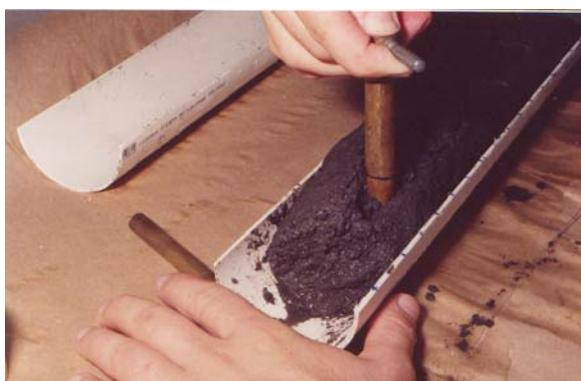
Figura 26 – Retirada das alíquotas de sedimento do testemunho TCV 1A para análise da atividade do  $^{210}Pb$  no espectrômetro gama.
