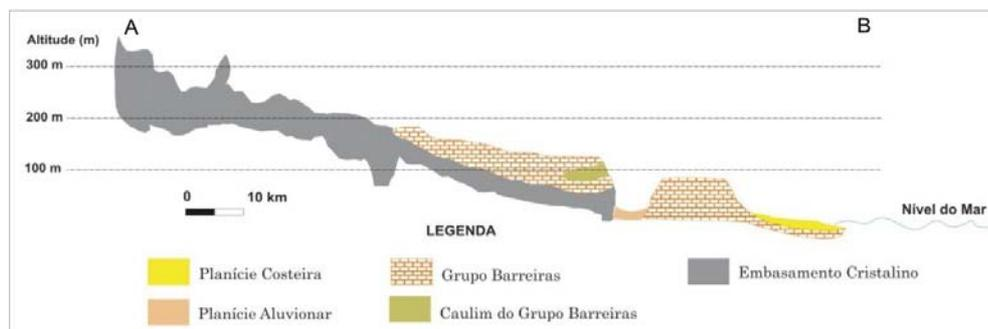
Figura 04 – Domínios geomorfológicos e curvas de nível presentes no Extremo Sul da Bahia, modificado de CBPM (2000a). Curvas de nível, modificado de IBGE (2004). Seção longitudinal adaptado de CBPM (2003).
