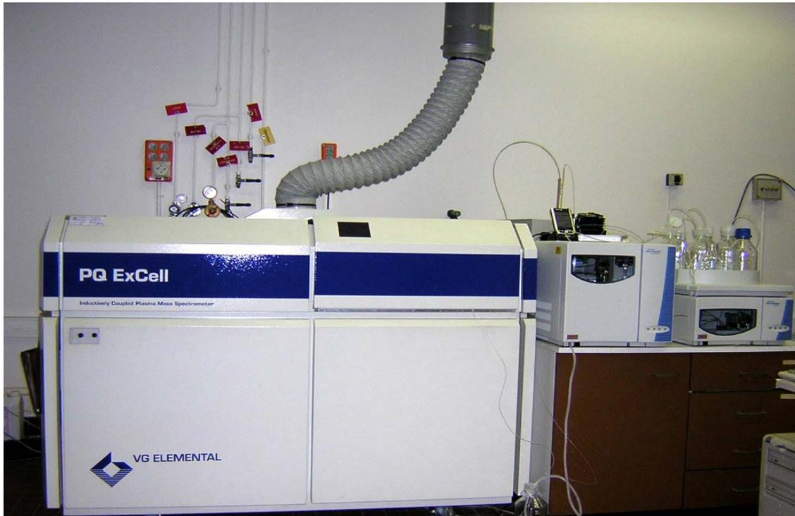
Figura 29 – Espectrômetro de massa-plasma de alta resolução ICP – MS, utilizado na identificação dos elementos químicos presente nas amostras.
