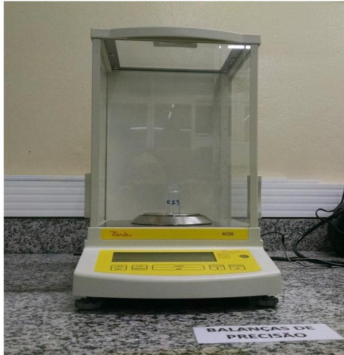
**Figura 5** - Pesagem do frasco de coleta do material extruído em balança de precisão
