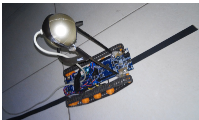
(a) Montagem da webcam no RobotShop Rover .
