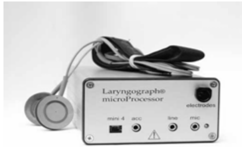
Figura 65: Sistema de aquisição do sinal de EGG
