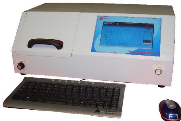
Figura 3.5 – Atual versão Espectrofluorímetro UV-Vis - Q798FIL.
