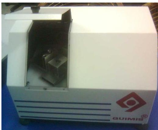
Figura 3.3 – Segunda versão do Espectrofluorímetro Q798FIL.
