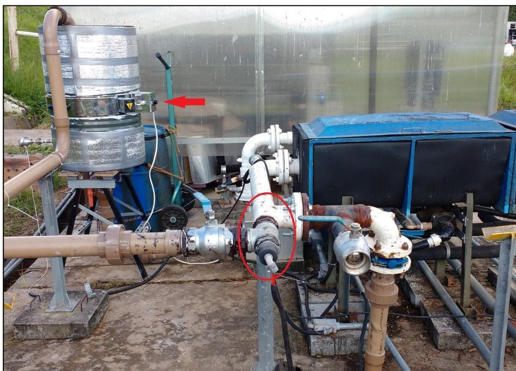
A vazão da linha é controlada pela variação da velocidade da bomba, através da ação de um inversor de frequência. O monitoramento da vazão é feito por um medidor do tipo placa de orifício. O medidor de vazão, que pode ser visto na Figura 22, foi instalado na primeira seção reta, logo após a saída da bomba, e possui um orifício de 50 mm de diâmetro.
