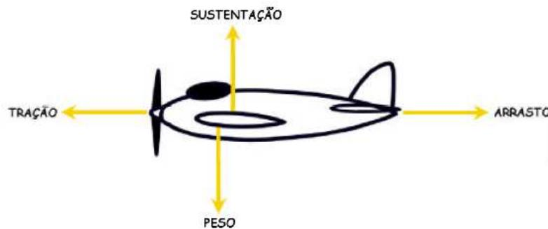
**Figura 2.2.** Principais forças que compõem a dinâmica da aeronave.
