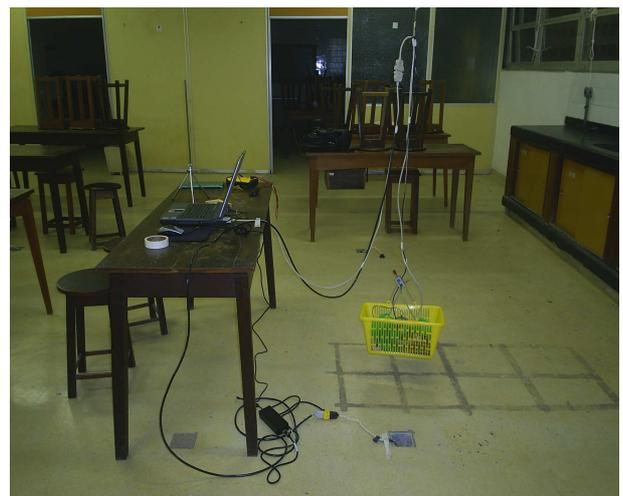
**Figura 5.3.** Montagem final do ensaio de pêndulo simples.
