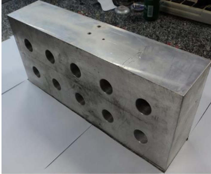
Figura 10. Bloco de alumínio utilizado no aquecimento das amostras.
