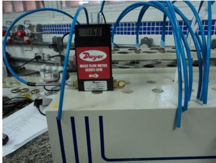
Figura 17: Conexão do Fluxímetro na Mangueira de Distribuição
