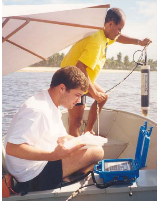
Figura 20 - Coleta dos parâmetros de salinidade e turbidez no estuário do Rio Jacuípe, com o auxílio da sonda hydrolab.
