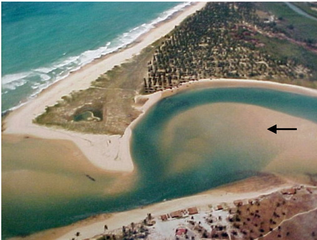
Figura 37 - Barra de desembocadura do estuário do Rio Jacuípe, mostrando em detalhe (seta) o delta de maré enchente.
