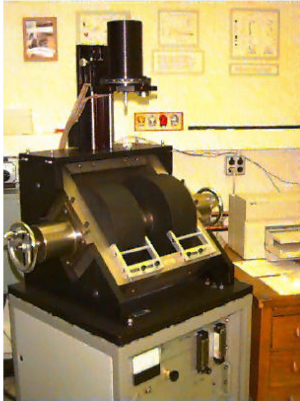
Fig. 3.8 Le Micro VSM de Princeton Measurements Corporation qui permet de mesurer l'aimantation en fonction du champ appliqué.
