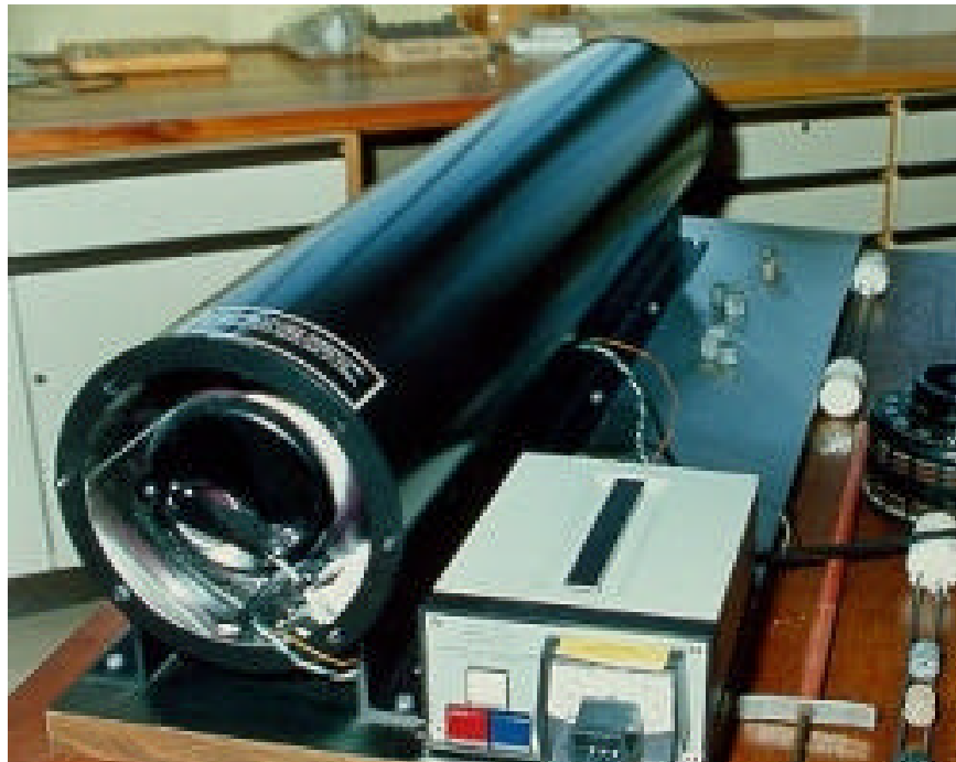
Fig. 3.6 Le four Schonstedt TSD-1, utilisé pour la désaimantation thermique des échantillons dans un intervalle de température de 0°C à 800°C, avec chambre de chauffage et refroidissement en champ nul.
