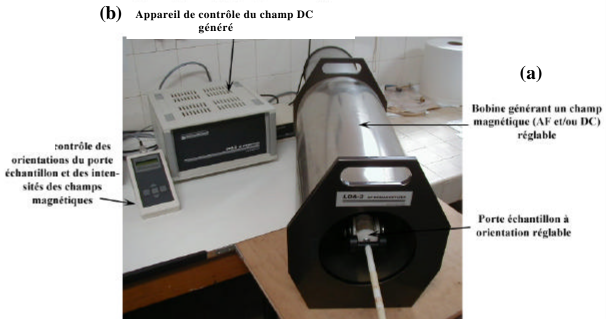
Fig. 3.5 Le désaimanteur AF LDA-3 (a) avec sa bobine génératrice de champ et son porte échantillon. L'aimanteur AMU-1A (b) est une autre bobine, coaxiale, à l'intérieur de la grande bobine; on voit l'appareil de contrôle du champ et la petite console de contrôle des rotations du porte échantillon et des intensités des champs magnétiques (AF et DC). L'ensemble est protégé du champ terrestre par du mu-métal.
