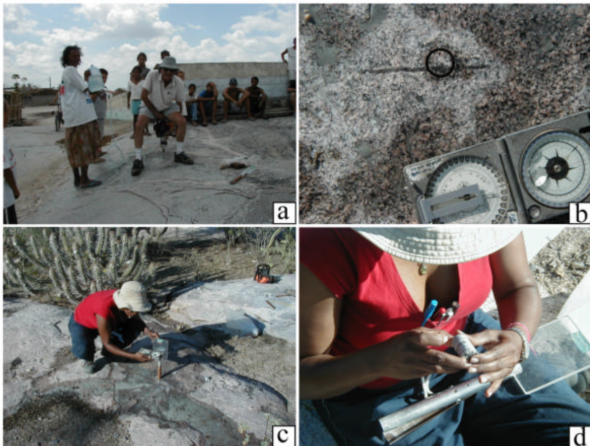
Fig. 3.1 Technique d'échantillonnage sur le terrain. Foreuse portative (a); repérage de la position de la carotte (b); orientation avec la boussole et l'orientomètre avant prélèvement (c) et marquage (d).
