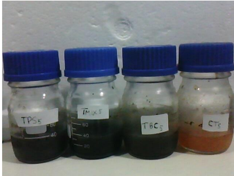
FIGURA 11 – Formação de sulfeto de ferro (precipitado negro), indicando a atividade das BRS na redução do sulfato.
