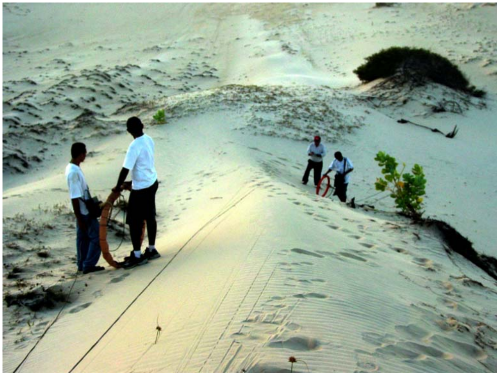
Foto 8.3 - Emprego do equipamento EM-34-3XL, sobre as dunas recentes, num arranjo com DH-10, espaçamento de 10 metros em ambos lados e profundidade de 7,50m.
