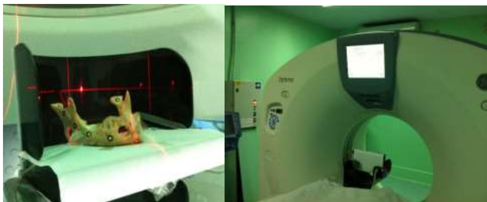
Figura 3: Posicionamento da mandíbula seca no aparelho de TCMS 128
