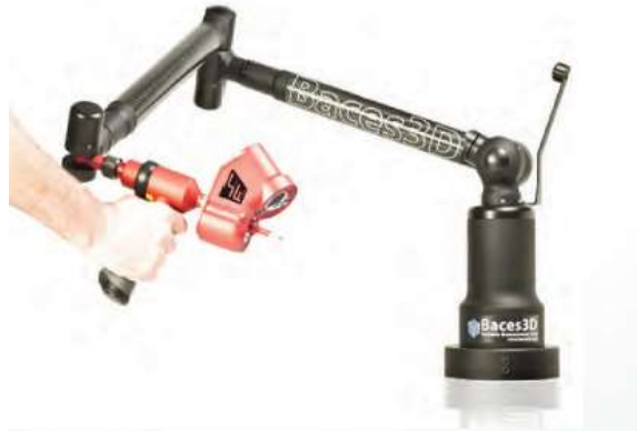
Figura 5: Escâner 3D Scanflex® montado na base Baces3D®, utilizados no estudo
