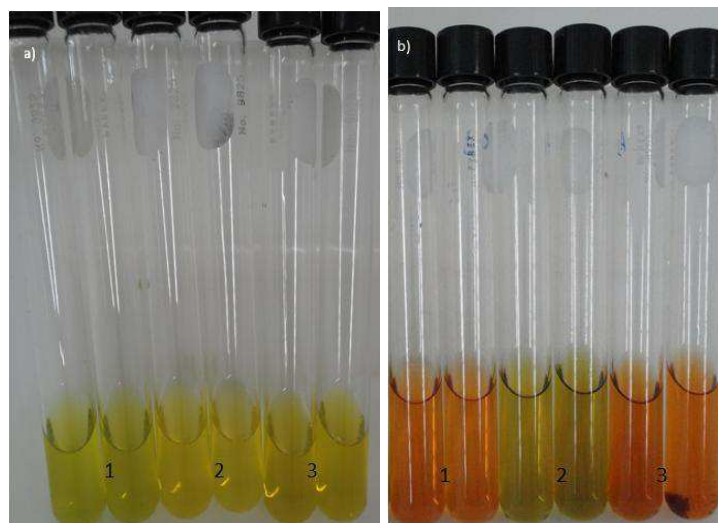
Figura 5.13 – Amostras do \beta -caroteno extraído da D.salina (a), onde 1- cultivo controle; 2-cultivo em estresse por deficiência de nitrogênio; 3- cultivo em estresse luminoso. Em (b) amostras de astaxantina extraída da H. pluvialis , onde 1- cultivo em estresse por deficiência de nitrogênio; 2- cultivo controle; 3- cultivo em estresse luminoso.
