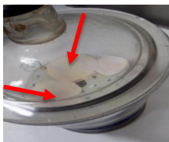
Figura 11 - Filtros de fibra de vidro
