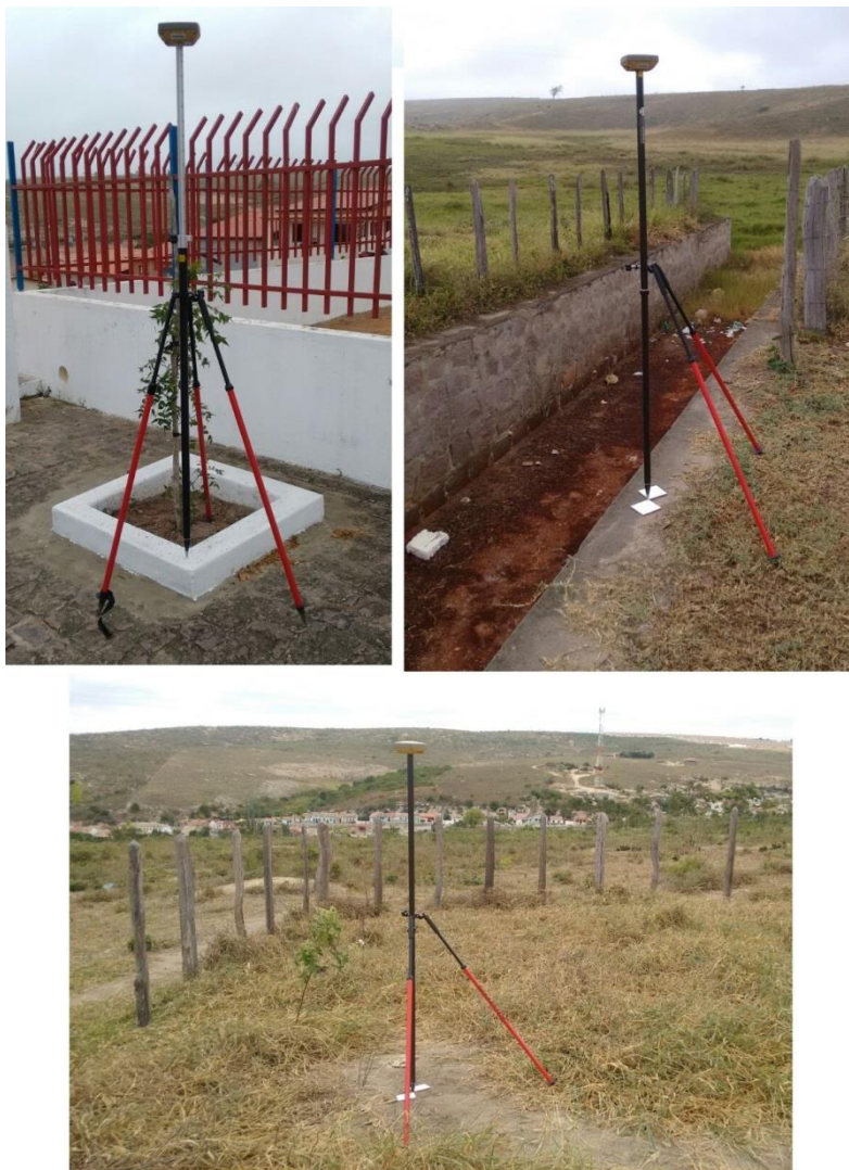
Figura 22: Pontos de Apoio coletados em campo, alvos pré-sinalizados (cerâmica de 16x16cm) e feições urbanas fotoidentificáveis.
