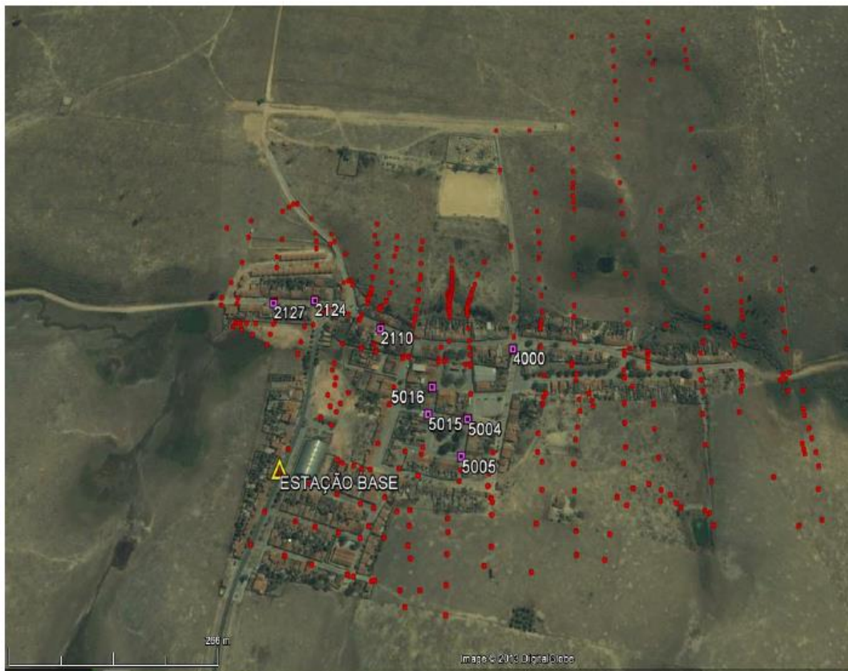
Figura 20: Os pontos em vermelho representam a disposição espacial do levantamento realizado pela Equipe da UFBA; os pontos em roxo indicam onde foram medidas as alturas máximas da enchente.
