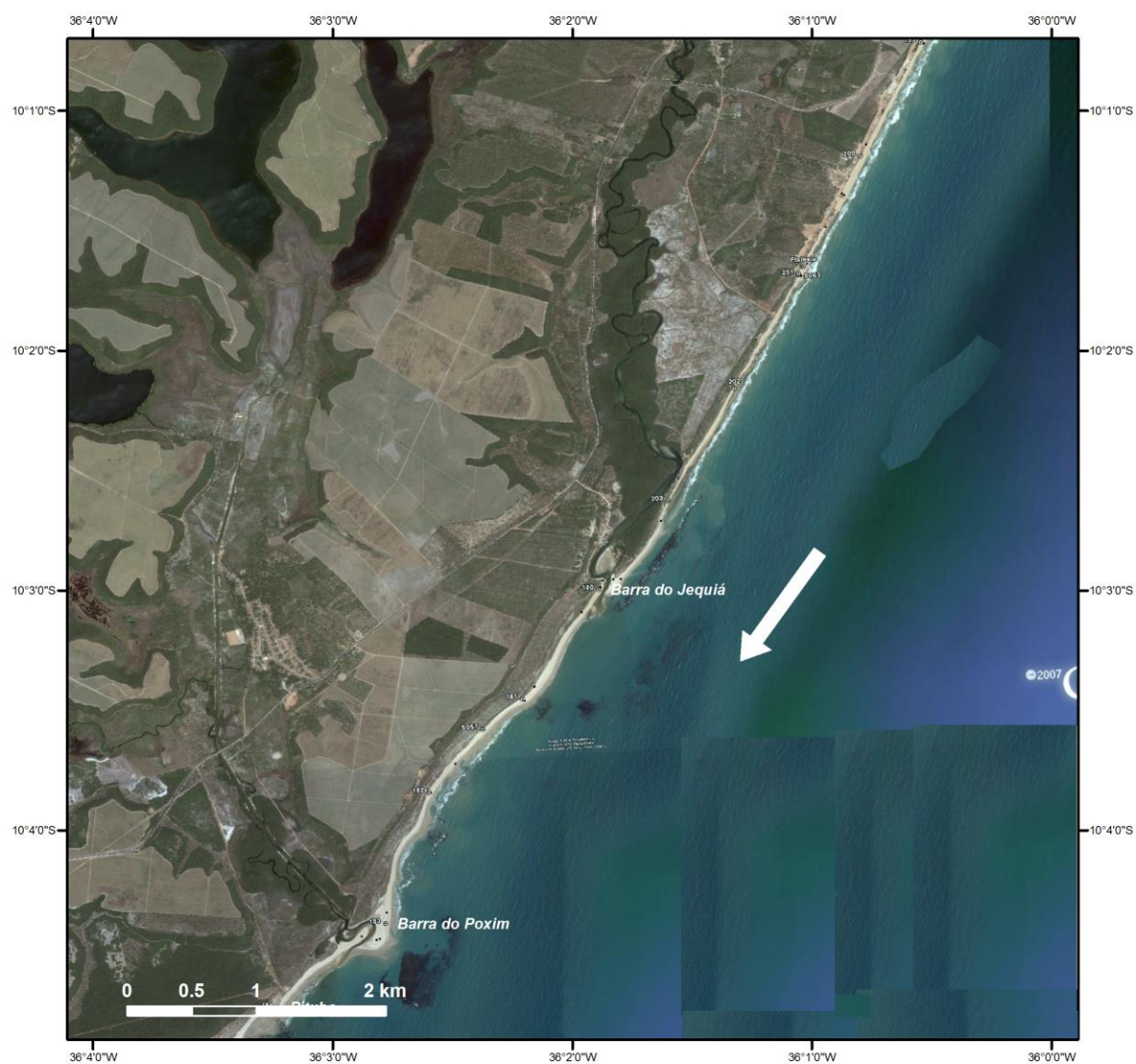
Figura 22 – Indicador geomórfico de sentido de transporte litorâneo, indicado pelo pontal arenoso da Barra do Jequiá. A seta branca indica o sentido de crescimento do pontal arenoso (para localização ver figura 15).
