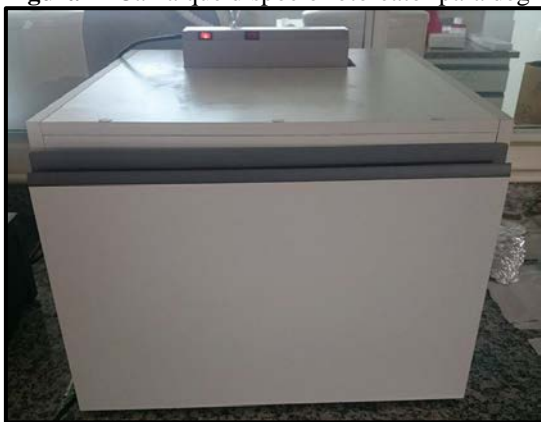
Figura 2- Caixa que dispõe o fotoreator para degradação de HPAs
