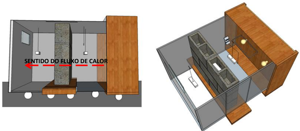
Figura 45: Vista frontal e Perspectiva da Câmara térmica.
