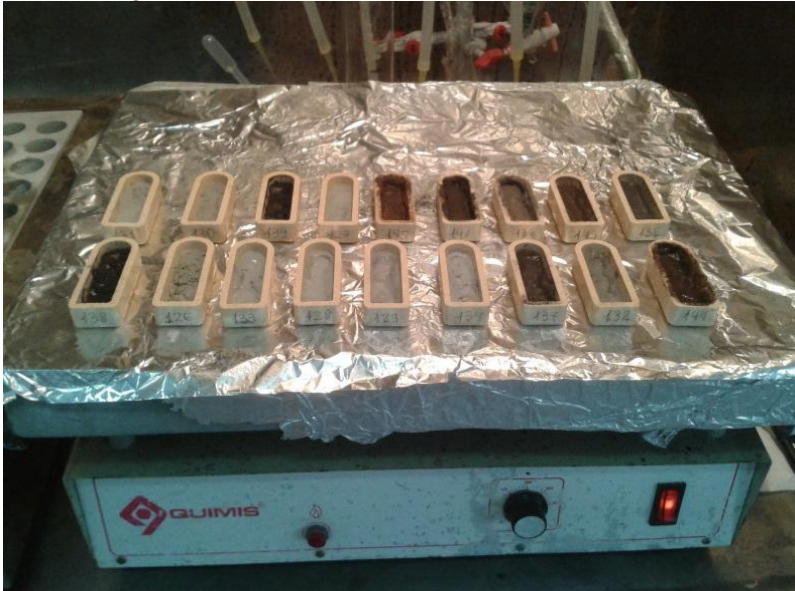
Figura 12 – Barca de porcelana em manta aquecedora para remoção da umidade antes da leitura do carbono orgânico total (COT)
