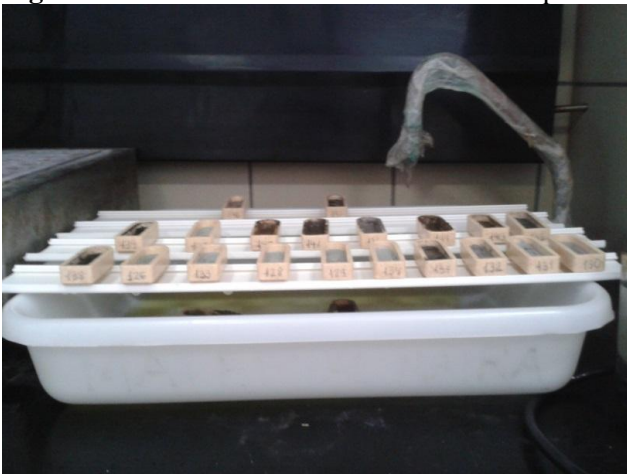
Figura 11 – Ácido sendo filtrado na barca de porcelana previamente a determinação do COT
