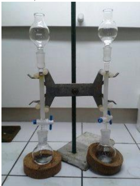
Figura 17 – Cromatografia líquida gravimétrica com colunas de sílica gel (fase estacionária) empregada na separação das três principais frações de componentes do petróleo, hidrocarbonetos saturados, aromáticos e resinas e asfaltenos
