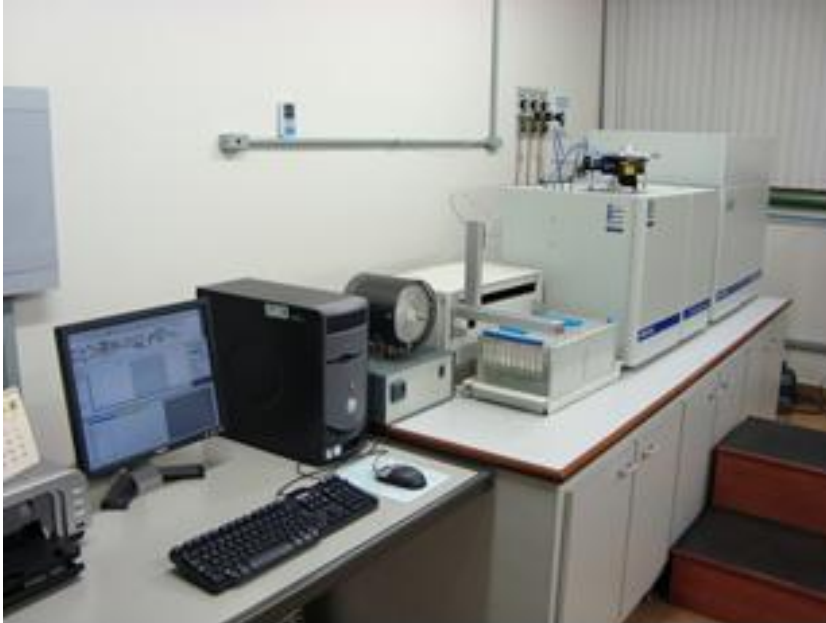
Figura 18 – Espectrômetro de massas acoplado com cromatografia gasosa PDZ-Europa, modelo SLG 20-20, utilizado para análises isotópicas de \delta^{13}\text{C} em amostras de rochas geradora e reservatório do sistema petrolífero Irati-Pirambóia
