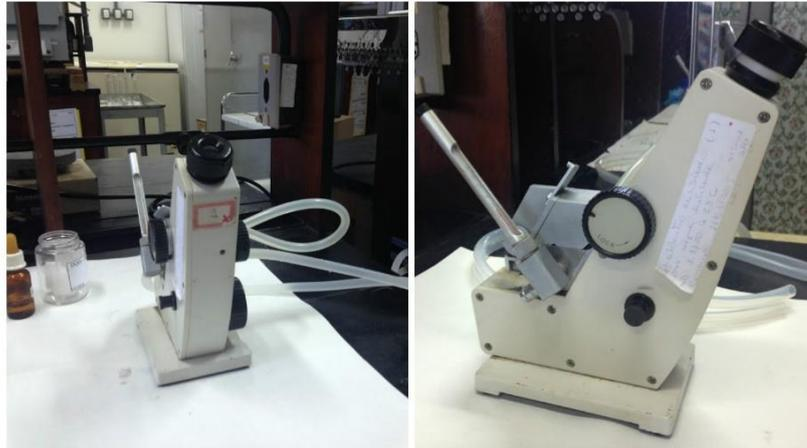
Figura 3.1- Refratômetro de bancada utilizado para análises de índice de refração.
