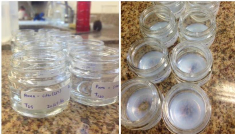
Figura 3.6- Cápsulas utilizadas para secagem de alíquotas nas análises de conversão pelo método de gravimetria.
