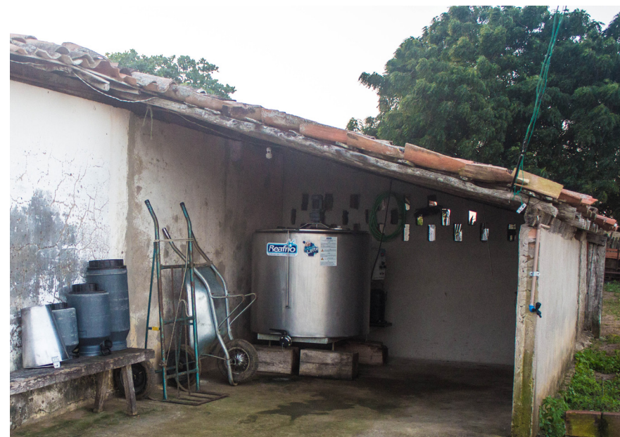
▲ Figura 29. Resfriador de leite em uma fazenda particular em Macajuba, com capacidade de 600 litros. Fotografia pela autora (2017).
