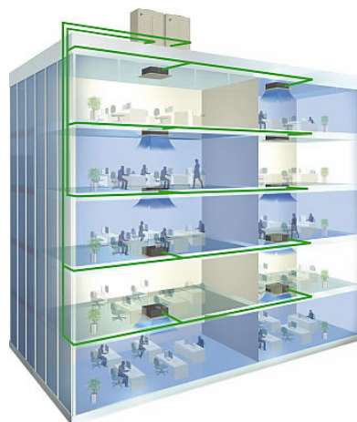
FIG.79 - Sistema de ar condicionado Multi Split
