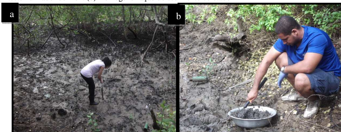
Figura 2 - Coleta de sedimento da zona de manguezal da Baía de Todos os Santos. (a) Coleta de sedimentos com testemunhador de inox. (b) Homogeneização do sedimento coletado
