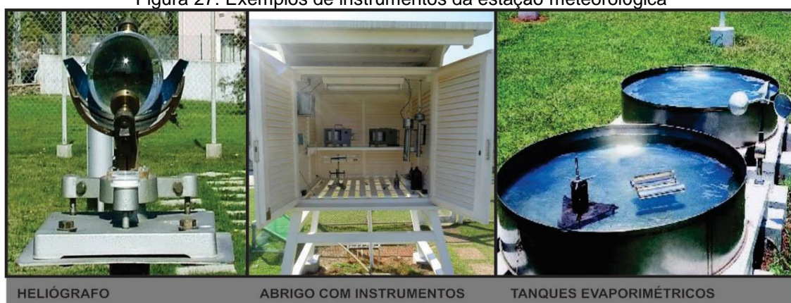
Figura 27: Exemplos de instrumentos da estação meteorológica
