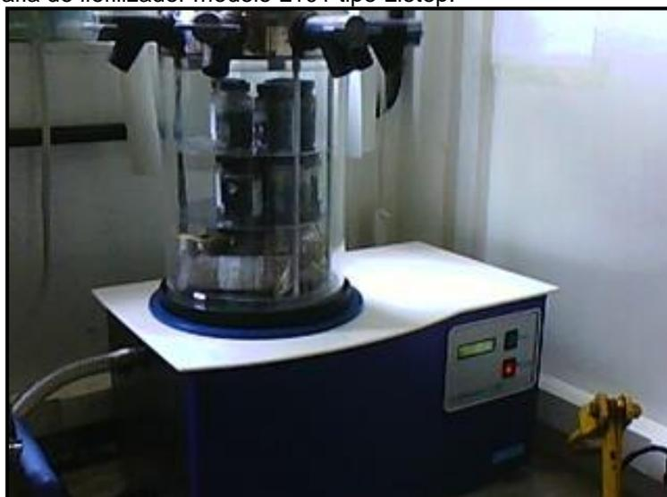
**Figura 3.4** - Fotografia do liofilizador marca TERRONI FAUVEL e modelo LT6000
