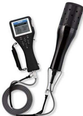
Figura 5. Sonda Multiparâmetro utilizada no campo para aquisição de dados (STD, Temperatura, Salinidade, CE, Turbidez, Eh e OD). Fonte: <http://www.analyser.com.br/>
