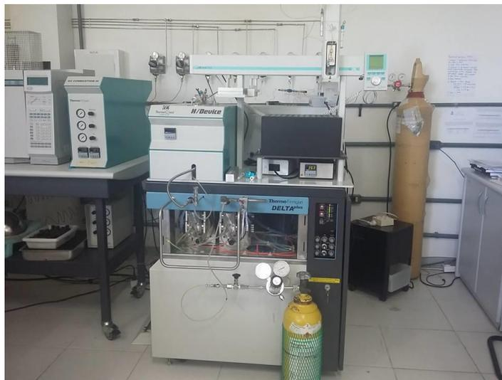
Figura 7. Equipamento para Medidas de  $\delta^{13}\text{C}_{\text{DIC}}$  - LFNA (Finningan GasBench). Foto:autora.
