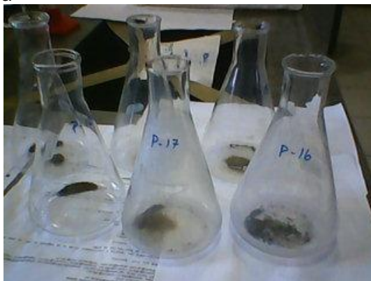
Figura 2.7 - Foto representativa da etapa de preparo do erlenmeyer com amostras para a titulação do conteúdo de matéria orgânica
