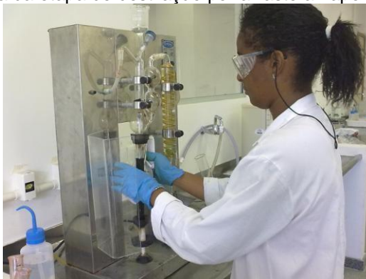
Figura 2.8 Foto representativa da etapa de destilação por arraste a vapor no titulador Kjeldahl
