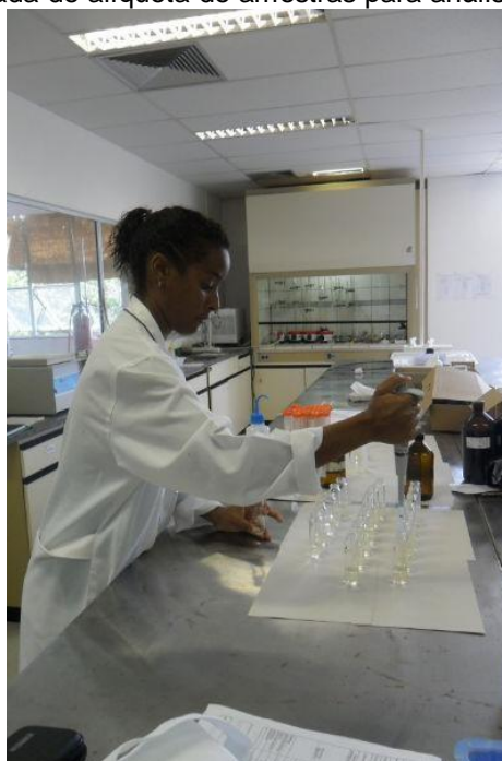
Figura 2.6- Foto da etapa de retirada de alíquota de amostras para análise de fosforo assimilável
