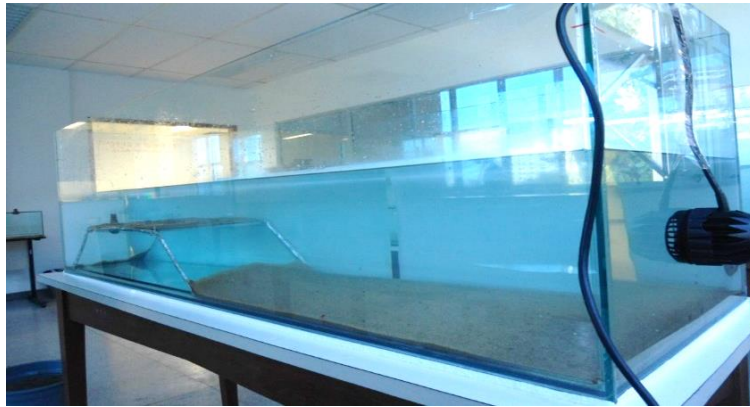
Figura 6.2 Unidade de simulação de praias dissipativas
