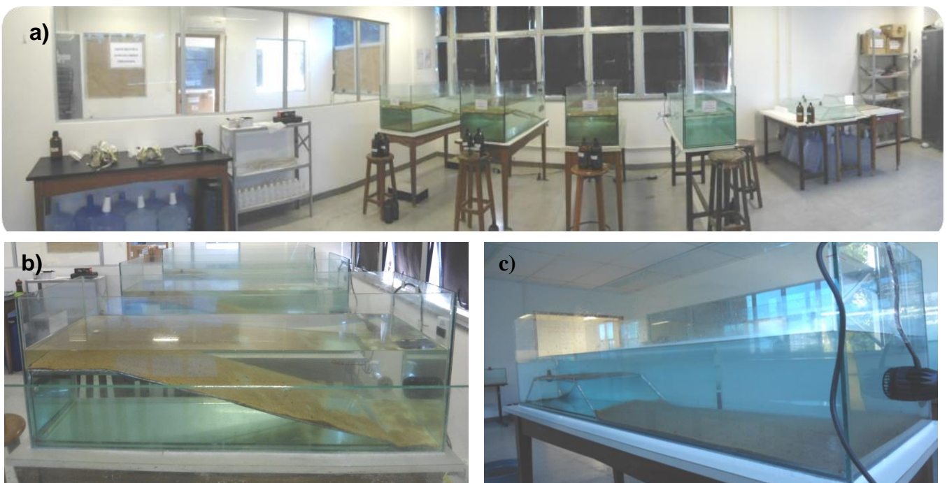
Figura 3.4. a) vista geral da sala de experimentos; b) unidades de simulação de praias refletivas e c) unidades de simulação de praias dissipativas
