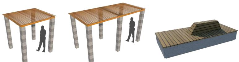
Pergolados com estrutura de apoio em cobogós de concreto aparente com acabamento liso e rugoso intercalados. Fechamento superior em madeira de gamboa oriunda do CEASA, apoiadas em perfil metálico.
