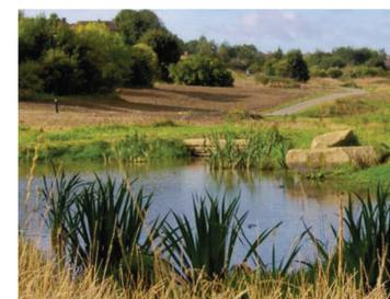
Jardim filtrante durante momento de cheia e durante período seco. Funciona como elemento estético de composição da paisagem e auxiliar na limpeza de águas pluviais.
