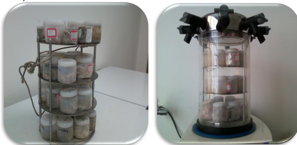
Figura 2.5 – (a) Preparo das amostras na grade do liofilizador e (b) Amostras sob o processo de liofilização
