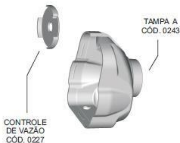
Figura 7 – Imagem das peças da frente da bomba
