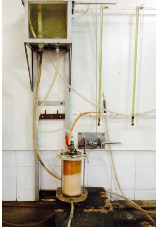
Figura 4.2. Ensaio para a determinação do coeficiente de permeabilidade realizado no laboratório de geotecnia (LABOTEC 1) do Departamento de Tecnologia da Universidade Estadual de Feira de Santana (UEFS)
