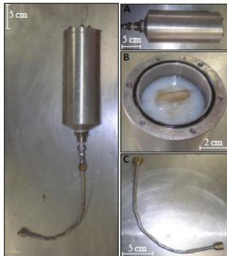
Figura 4.7. Imagem ilustrativa do silo onde são armazenados os fluidos que serão injetados na coluna utilizada no processo de lavagem: (A) Corpo do silo; (B) Êmbolo móvel flutuante; (C) Tubo em “L”.
