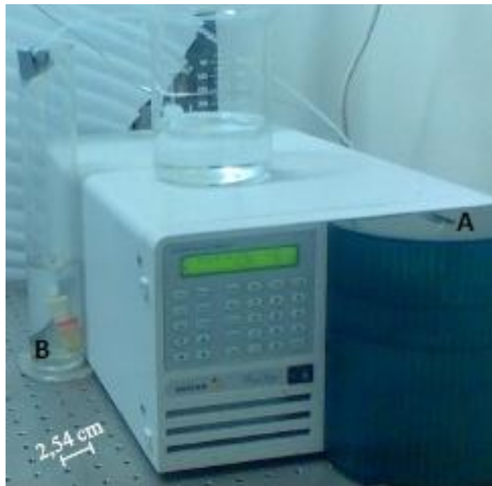
Figura 4.8. Imagem ilustrativa do sistema de injeção utilizado no processo de lavagem: (A) Bomba de HPLC e (B) proveta graduada.
