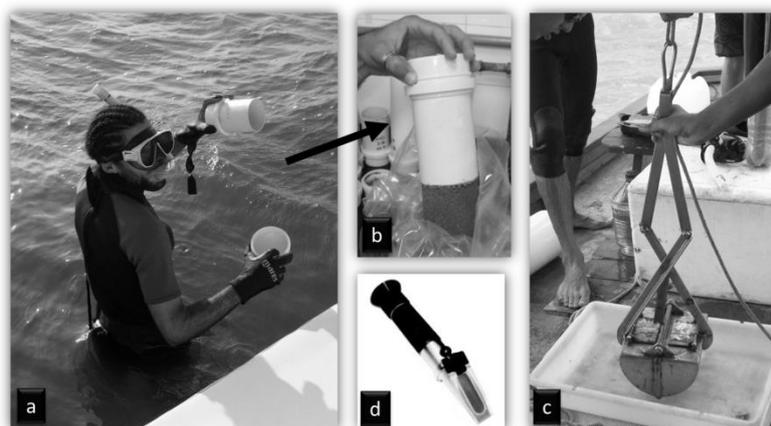
**Figura 3.** Coleta de dados biológicos por mergulhador (a) utilizando 'corer' ( $0,05 \text{ m}^2$ ) (b) e por van Veen (área=  $0,008 \text{ m}^2$ ) (c) e medida de salinidade com refratômetro (d).
