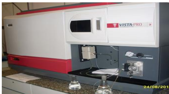
Figura 8. Espectrômetro de emissão óptica com plasma indutivamente acoplado (ICP OES).
