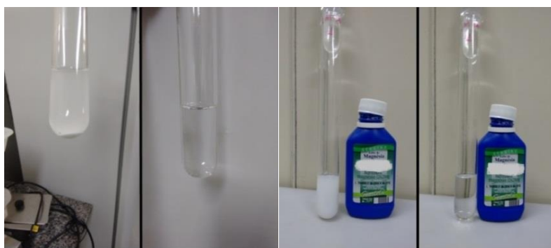
Figura 18. Aspecto visual da decomposição de suplemento mineral de Mg (esquerda) e leite de magnésia (direita) em HNO 3 2,0 mol L -1 utilizando o bloco digestor.
