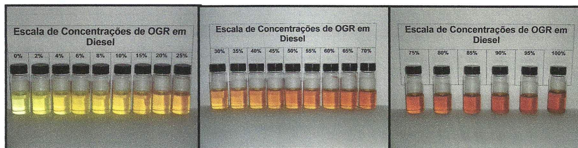
Figura 3. Método visual comparativo para identificação de possíveis adulterações do diesel por óleos vegetais (OGR). Fonte: Autoria Própria.
