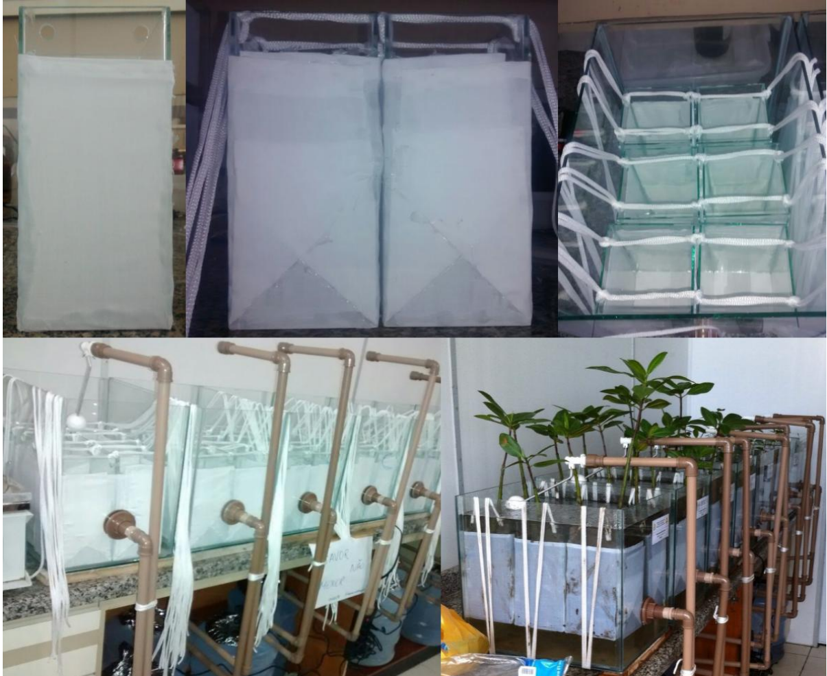
Figura 12 - Delineamento do processo experimental do sistema: (a) cubetas; (b) sistema montado, e sistema completo (sedimento, mudas e água), respectivamente
