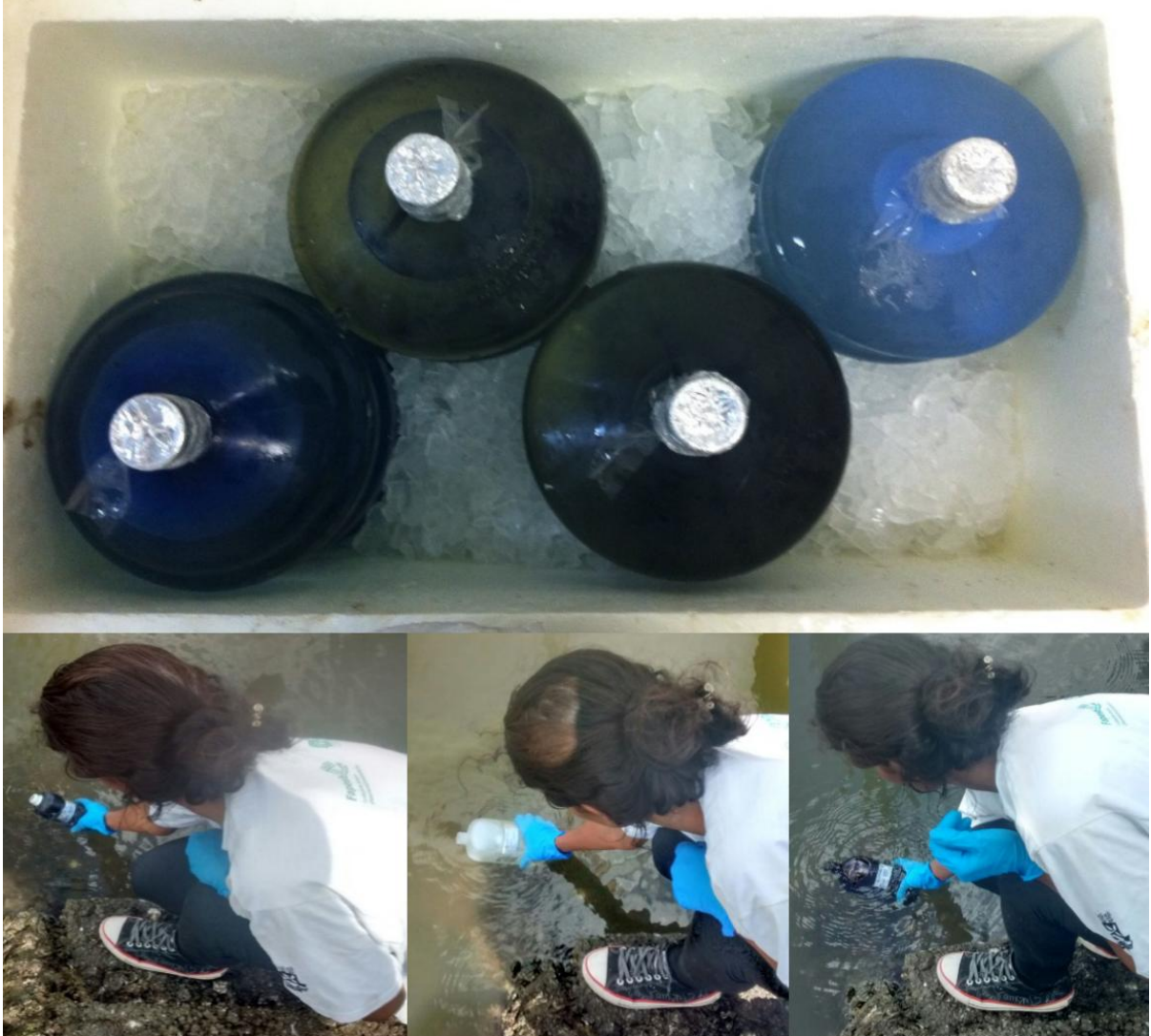
Figura 9 - Galões com amostra de água, devidamente resfriadas em laboratório; coleta de água para caracterização local
