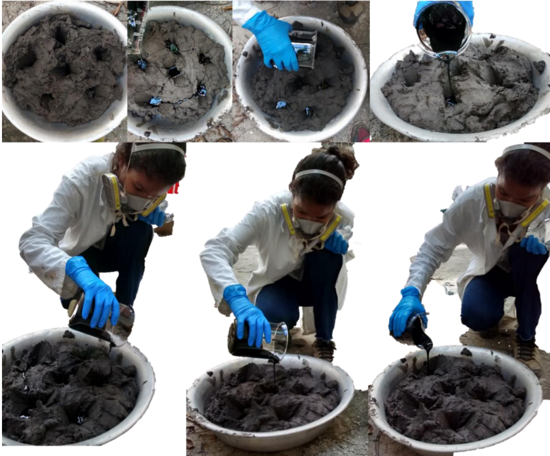
Figura 7 - Contaminação do sedimento com o óleo da Bacia do Recôncavo
