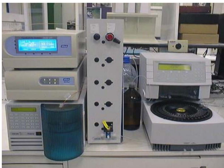
Figura 53 - Cromatógrafo iônico utilizado
