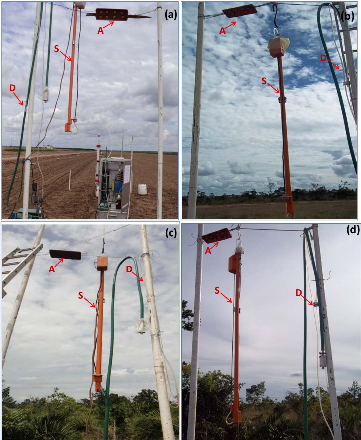
Figura 51 - Montagem do esquema de amostragem de ar no cerrado baiano: área de soja em época (a) chuvosa e (b) seca; área de cerrado nativo em época (c) chuvosa e (d) seca. A: amostradores passivos. S: sistema de termodifusão-Stroelhein. D: Denuder de ácido cítrico.
