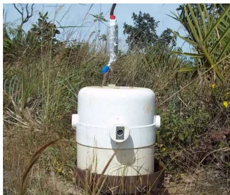
Figura 18 - Câmara estática instalada em campo
