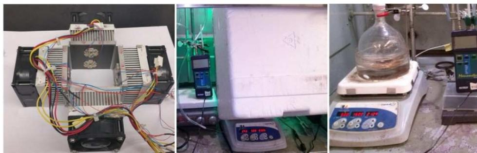
**Figura 11.** Reação de hidrogenação no escuro e sob luz visível constituída por LEDs verdes (potência  $\approx 500$  mW).
