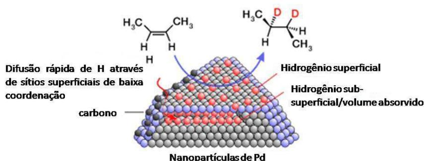
**Figura 25.** Esquema mostrando a conversão do cis-2-buteno para butano-D<sub>2</sub> através dos diferentes níveis em que o Hidrogênio pode interagir tanto na superfície quanto nas sub-superfícies das NPs-Pd facilitando a hidrogenação. Adaptado de Ludwig *et al.*, 2010.
