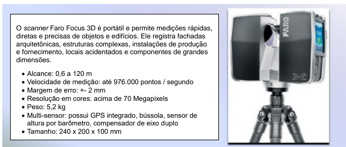
Figura 50 – Características do laser scanner Faro Focus 3D
