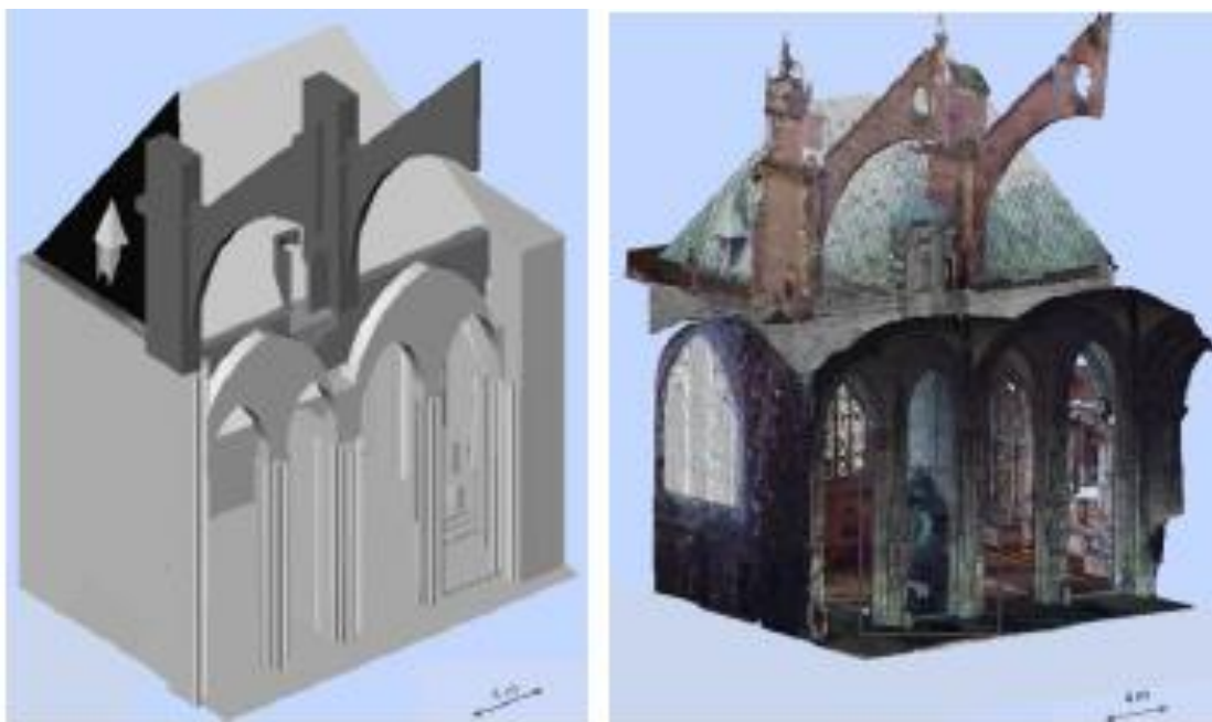
Figura 25 – Modelo geométrico: à esquerda, baseado em primitivas; à direita, baseado em malhas
