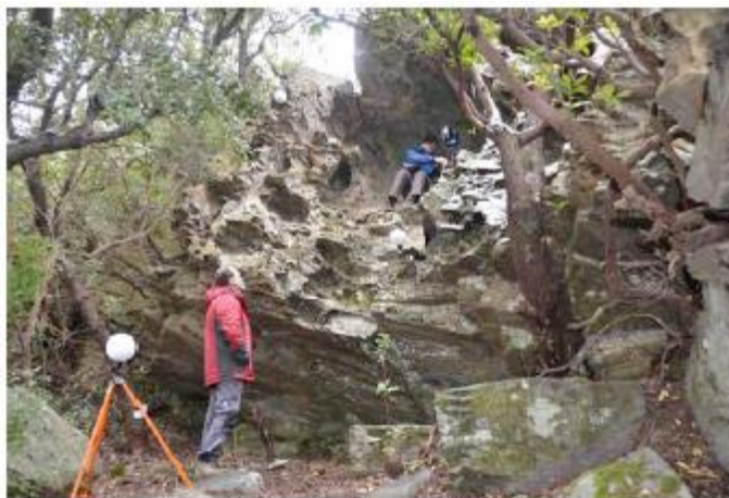
Figura 23 – Faro Focus 3D montado na parte superior da caverna
