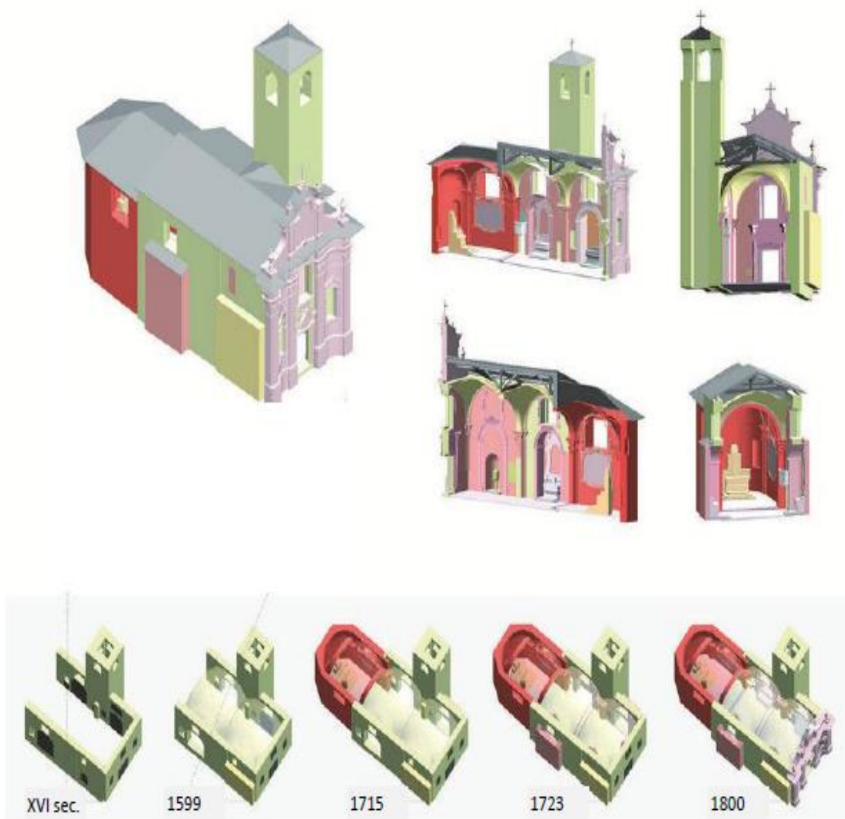
Figura 17 – HBIM das diferentes fases da construção (estratigrafia)
