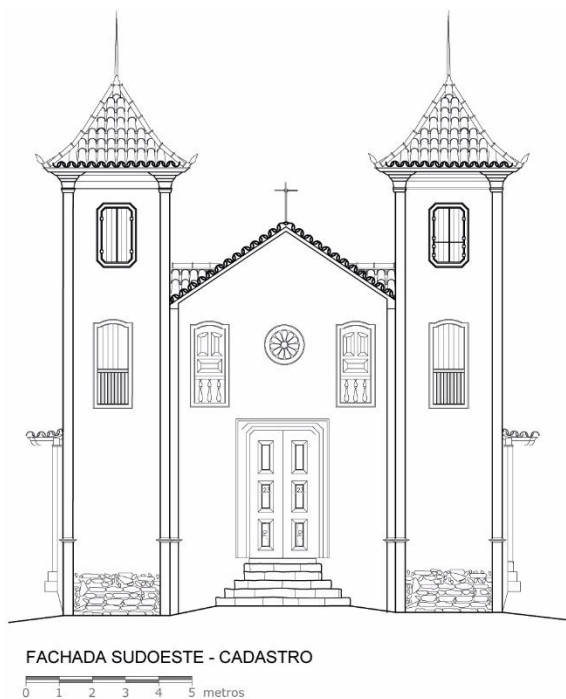
Figura 46 – Cadastro: Fachada Sudoeste
