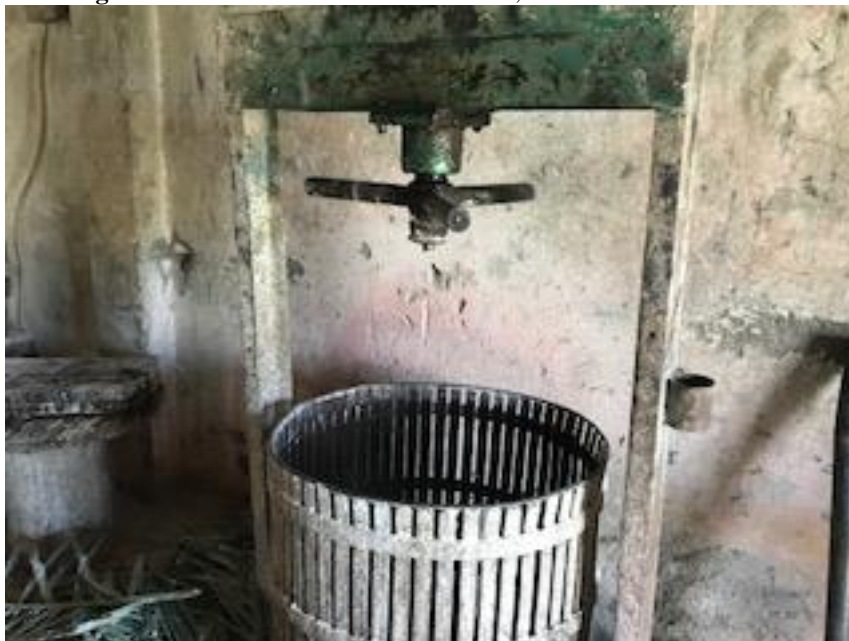
Figura 14: Prensa da massa da mandioca, Pau Ferro - Muritiba-BA
