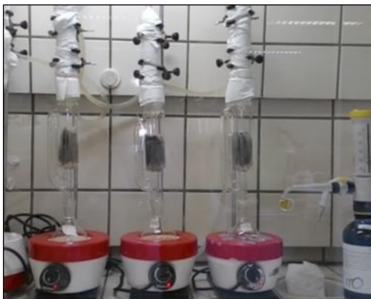
Figura 4. Sistema de extração Soxhlet utilizado no LEPETRO/NEA/IGEO/UFBA
