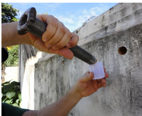
FIGURA 23- Acondicionamento da amostra de argamassa no coletor universal.
