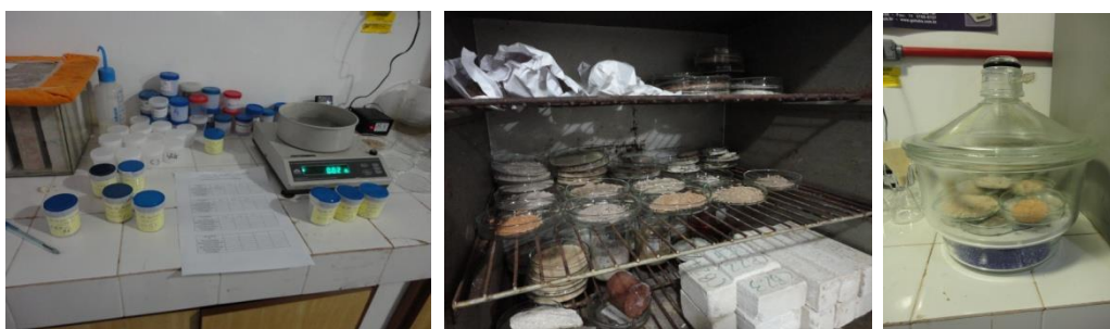
FIGURAS 30, 31 e 32- As amostras sendo conferidas e pesadas, armazenadas na estufa por 24 h e resfriadas no dessecador.
