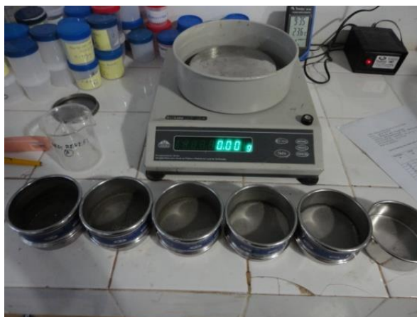
FIGURA 42- Conjunto de peneiras e balança de precisão, equipamentos essenciais para o ensaio de granulometria do agregado.
