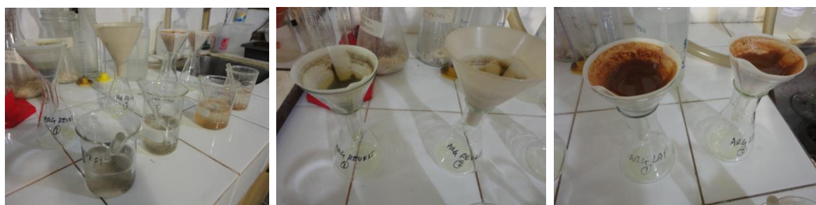
FIGURAS 36,37 e 38- Ensaio de determinação do traço em massa. Dissolução dos ligantes com HCl + H 2 O (1:4).
