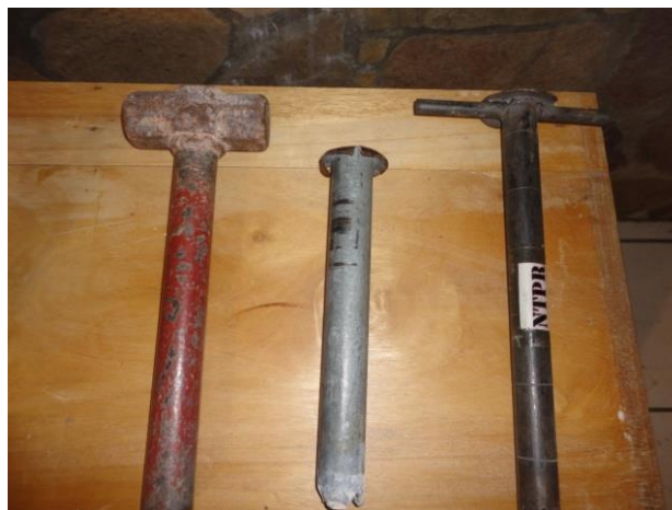
FIGURA 20- Ferramentas utilizadas na coleta de amostras da argamassa da Fonte das Pedras, extratores e marreta.
