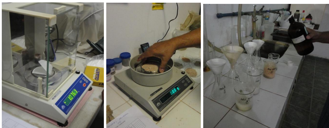
FIGURAS 33, 34 e 35- Ensaio de determinação do traço em massa. Pesagem dos filtros, das amostras e dissolução dos ligantes com HCl + H 2 O (1:4).
