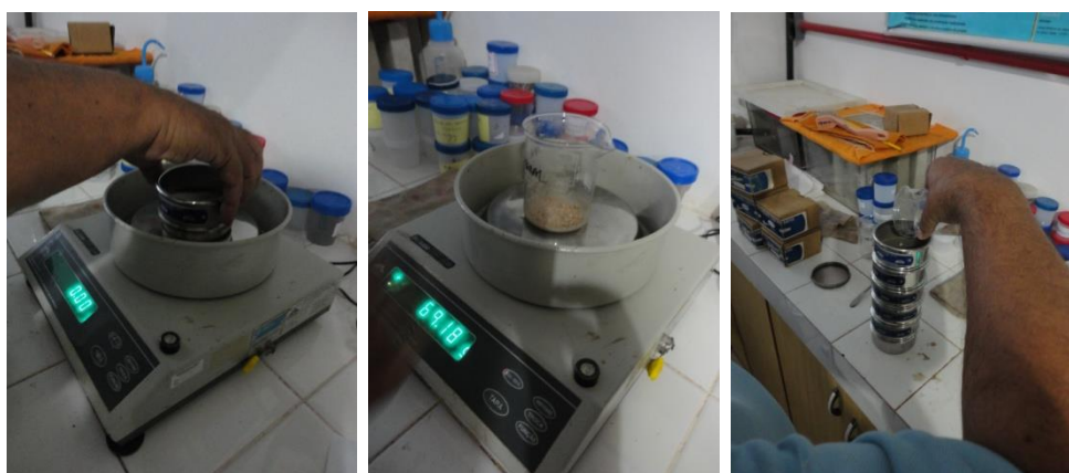
FIGURAS 43, 44 e 45- Pesagem das peneiras e da amostra e colocação da mesma no conjunto de peneiras. Com a vibração e o efeito da gravidade, as partículas tendem a cair sendo retidas nas telas de cada peneira, podendo-se verificar seu diâmetro.
