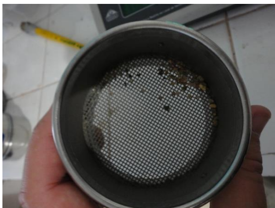
FIGURA 46- Partículas do agregado retidas em uma das peneiras.
