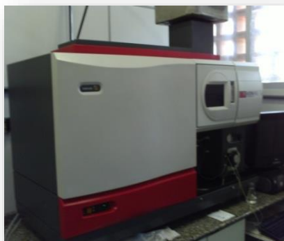
Figura 06. (a) Espectrômetro de emissão óptica com plasma empregado no trabalho; (b) Tocha na configuração axial.
